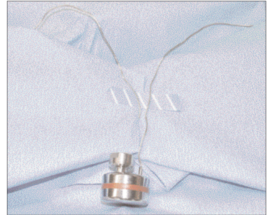
Druck-Temperatur-Datenlogger EBI-125 A PD3 – mit biegsamen Temperaturfühlern. Durchmesser <2 mm.
