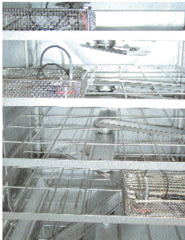
Anordnung der ebro-Logger in der zweiten und dritten Spülebene sowie der fünften Ebene zur Messung im Abluftstutzen.
