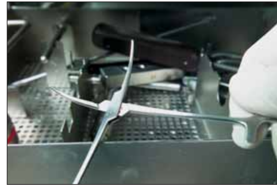
Abbildung 2: Referenzinstrument mit Restkontamination
