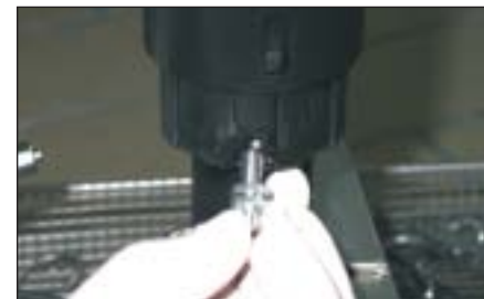
Abbildung 8: III. Schritt: Luerlock einschrauben.
