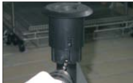
Abbildung 6: I. Schritt: ein 5-mm-Loch in den Feststerring des Adapters bohren.
