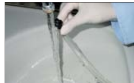
Abbildung 9: Schritt IV: den Anschlussschlauch des Loggers mit Wasser befüllen.
