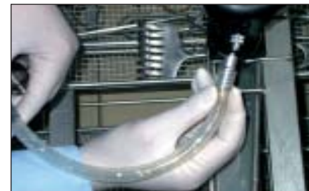
Abbildung 10: Schritt V: den Luerlock mit dem Anschluss verbinden.
