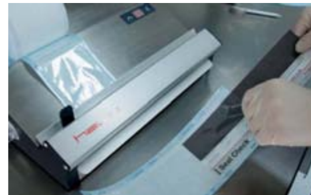
Siegelindikator »SEAL CHECK« nach DIN EN 868-3:2009
