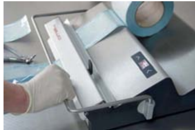
Voll validierbares Balkensiegelgerät »ValiPak®« mit Computer-Schnittstelle
