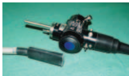
Olympus-Endoskop mit Transponder-Chip am Versorgungsstecker
