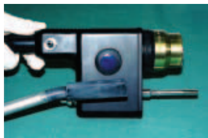
Pentax-Endoskop mit Transponder-Chip am Versorgungsstecker
