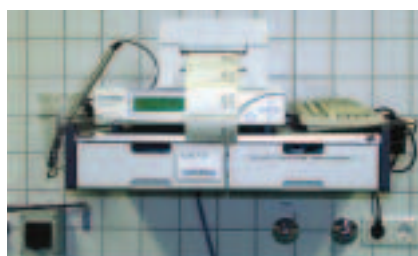
Endoscan-2-Endoskop- und Zubehör-Identifizierungs-Gerät mit Handscanner und Etikettendrucker von Olympus
