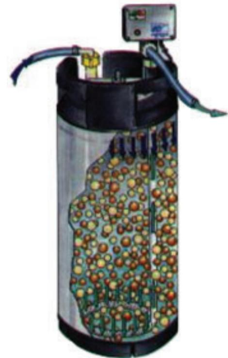
Abbildung 3: Schematische Darstellung einer Mischbett-Ionenaustauscherpatrone.
