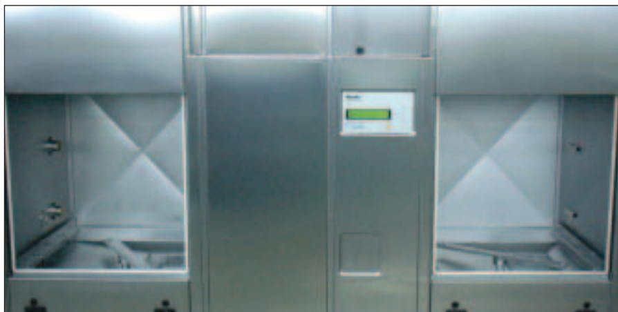
Allein der Blick in den Spülraum offenbart die gute Reinigungsleistung – im rechten Spülraum wurde das OxiVario-Verfahren angewendet.
