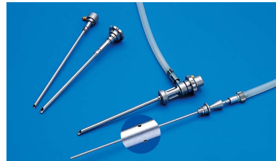
Bild 2 zeigt einen Saug-/Spülschaft, der früher zweiteilig hergestellt wurde (im Bild links oben). Die neue Version besteht aus einem Teil, welches durch die Verwendung von 2 Spül-adaptoren für die maschinelle Dekontamination konzipiert wurde. Der mit Spülbohrungen versehene Dorn für die Reinigung des zentralen Kanals, der zweite (nur für den Reinigungsschritt anzubringende) Adapter für die Reinigung des geometrisch komplexen Spülkanals zwischen Innen- und Außenrohr.
