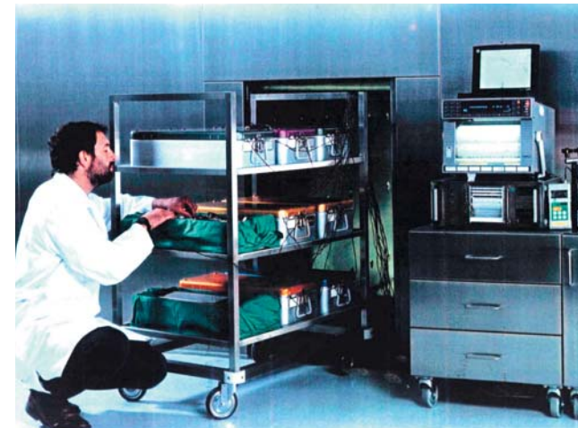
Abb. 2: Validierung von Sterilisationsprozessen. Hier: Platzieren von Thermoelementen.
