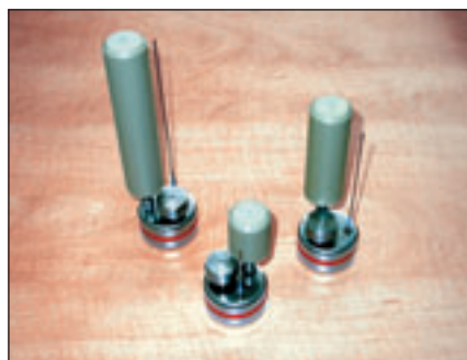
Abb.1 zeigt den Ebro PCD Logger EBI-125 A-PT mit aufgesetzten Hohlzylindern mit unterschiedlichen Längen: 50, 100 und 150 mm. Die Kontaktbelegung: Thermosensoren Kanal 2, 3 und ein Drucksensor
