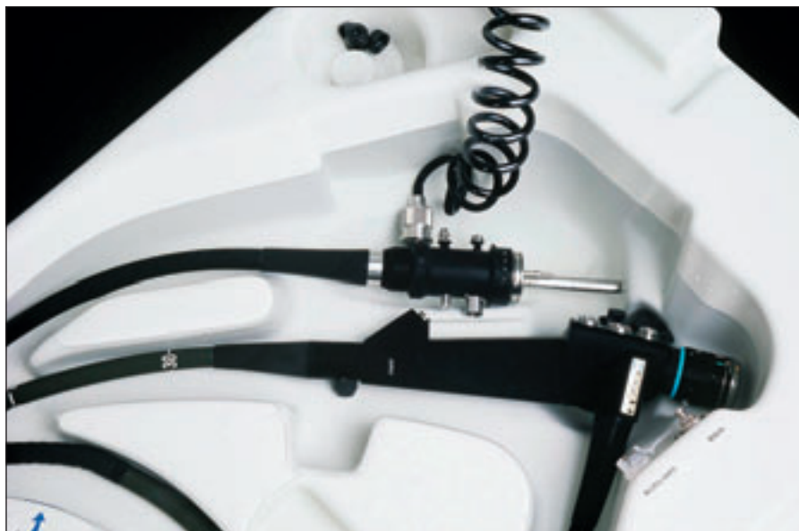
Endoskop mit angeschlossenem Dichtigkeitstest in einer Wanne.
