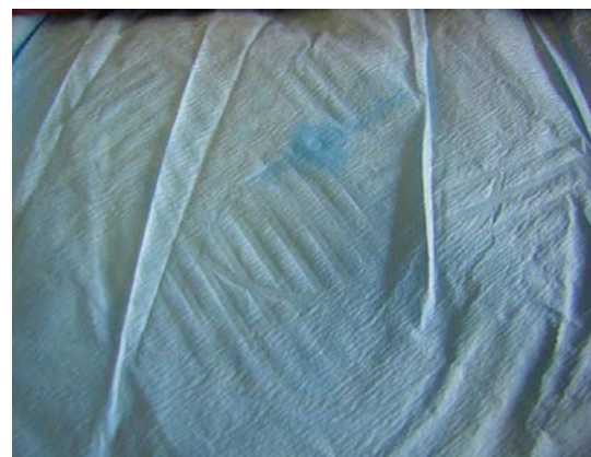
Abb. 4: Das Filtersystem drückt auf den Verpackungsbogen und kann nicht funktionieren. Zurück bleiben nasse Filter und Verpackungsbögen. Für den Aufbereiter ist dies nach der Sterilisation nicht sichtbar oder fühlbar, weil sich der Vorgang (für ihn unsichtbar) innerhalb des Containers abspielt.
