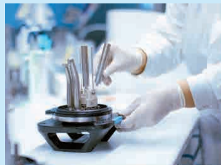
Foto 2: Dental-Prüfkörper für die Validierung (Foto: SMP GmbH)
