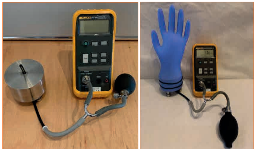
Abb. 3: Druckmessung über 30 Minuten bei ca. 15 mbar.
